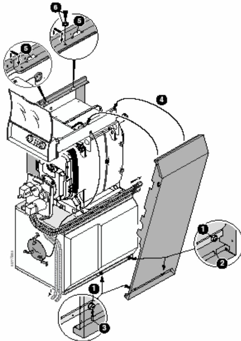
Alinear el borde del panel lateral sobre la parte trasera del acumulador y después colgar el panel sobre las hembrillas 1 del acumulador introduciendo las muescas 2 y 3 del panel lateral sobre las hembrillas 1 . 4 Poner recto el panel lateral y tirar de él hacia arriba. 5 Colgar el panel
