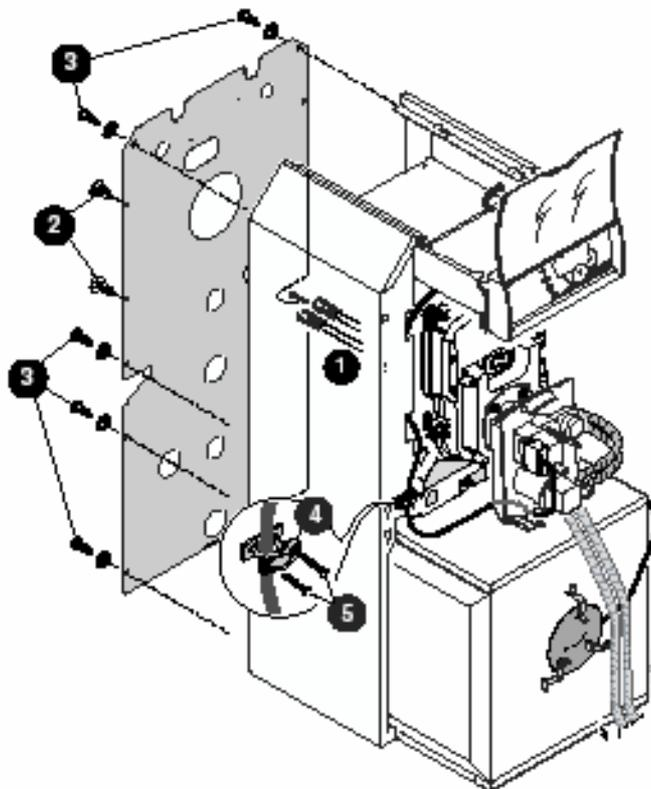
1 Hacer pasar los tubos flexibles de alimentación de gasóleo a través del recorte del panel trasero.
